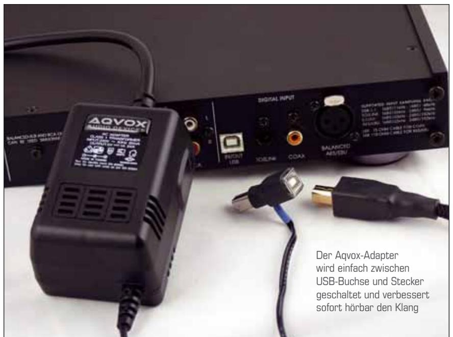
Der Aqvox-Adapter wird einfach zwischen USB-Buchse und Stecker geschaltet und verbessert sofort hörbar den Klang
