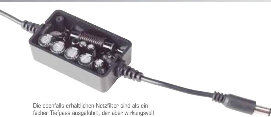
Die ebenfalls erhältlichen Netzfilter sind als einfacher Tiefpass ausgeführt, der aber wirkungsvoll hochfrequentes von den Leitungen bügelt
